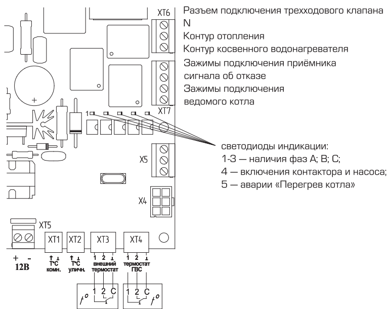
Рис. 5. Расположение разъемов на плате контроллера
